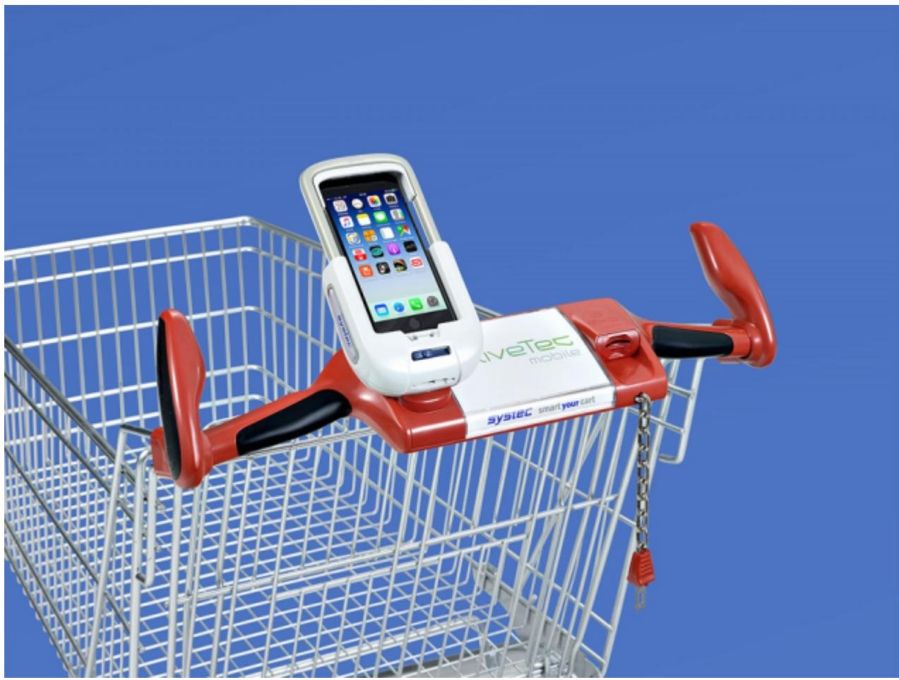
Рисунок 4. Телега с установленным терминалом для самостоятельного сканирования.
